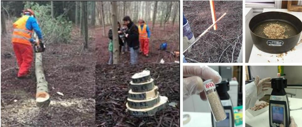
**OBTENCIÓN DE MUESTRAS DE ASTILLAS Y APLICACIÓN NIR PARA GENERACIÓN DE ESPECTROS Y FORMULACIÓN MODELO DE ESTIMACIÓN DE DENSIDAD BÁSICA DE LA MADERA**
