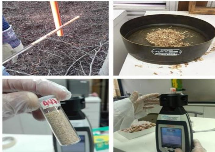
Obtención de muestras de astillas y aplicación NIR para generación de espectros y formulación modelo de estimación de densidad básica de la madera
