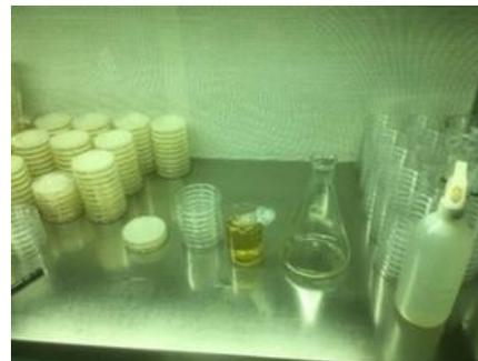
Esterilización de medios en autoclave a 1,2 Atm de presión y a 121°C por 30 minutos y Medios de cultivo vaciados con jeringa a discos de Petri desechables estériles
