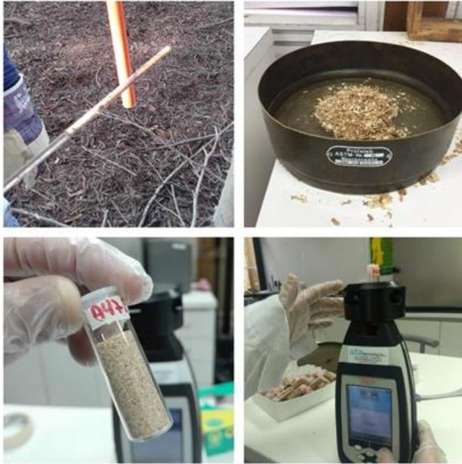
**Obtención de muestras de astillas y aplicación NIR para generación de espectros y formulación modelo de estimación de densidad básica de la madera**
