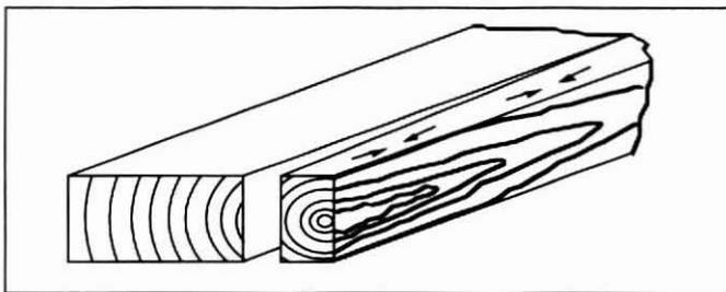
Figura 5. RAJADURAS CAUSADAS POR TENSIONAMIENTO INTERNO
