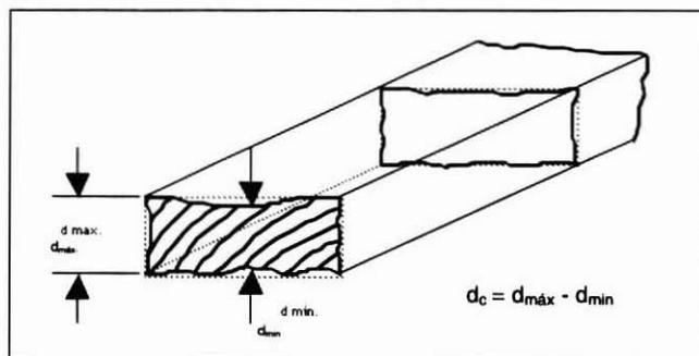
Figura 10: MÉTODO PARA LA EVALUACIÓN DEL COLAPSO
