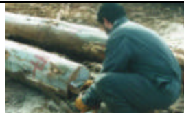
Sellado extremos trozas con cera liquida emulsionada
