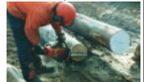
Corte en cruz para minimizar riesgo rajaduras
